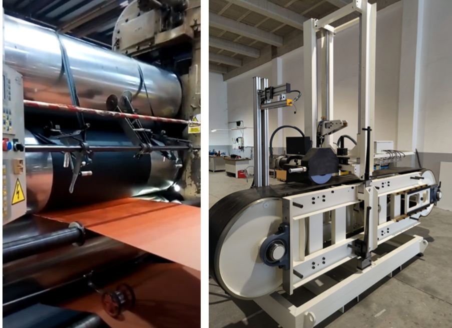
Figura 1: Imagen de calandra y detalle de fabricación de banda prototipo y unión a tejido ( izda. ). Equipo multipropósito para ensayar y validar bandas desarrolladas en BERTA en condiciones relevantes ( dcha. ).
